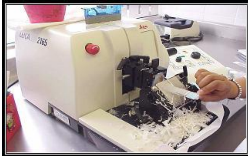
Imagen N.- 7. Micrótopo (Corte micrométrico de los tejidos incluidos en parafina). Hospital IEES Ambato.
