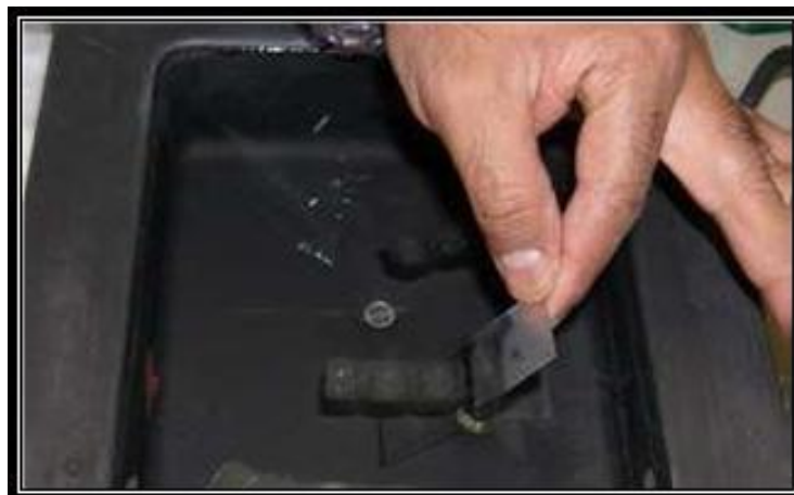
Imagen N.- 8. Baño de flotación (extendido del corte para su montaje y secado). Hospital IEES Ambato.
