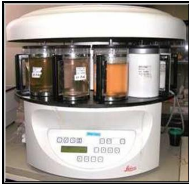
Imagen N.-5. Procesador automatizado de tejidos (fijación, deshidratación aclaramiento e, infiltración). Hospital IEES Ambato.
