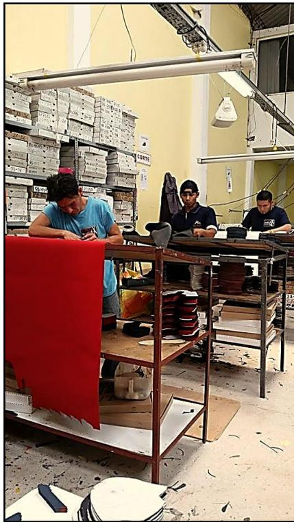
**Desvastado:** En este proceso se realiza el desbaste o la disminución del espesor del cuero para las partes de las piezas de corte que van a ser empastados o doblados y el obrero pinta los bordes de las piezas que van a estar visibles.
