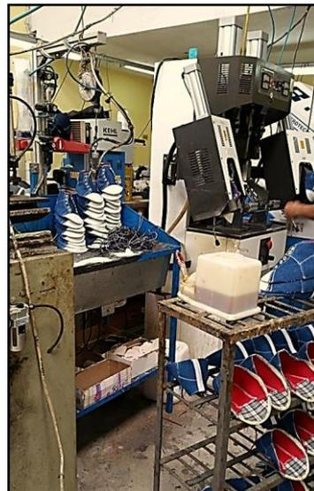
**Armar puntas.** Este proceso consiste en forrar la horma grapada con el corte de cuero previamente preparado, el operario primero vaporiza el corte, luego une con la horma colocando en la máquina armadora de puntas para cerrar el zapato.
