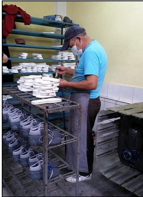
**Prensado.** En este proceso se unen la suela de TR con el zapato armado de cuero mediante el reactivado de pegamentos por medio de calor, se prensa el zapato y luego se saca de la máquina y se ejerce presión para mejor el pegado.
