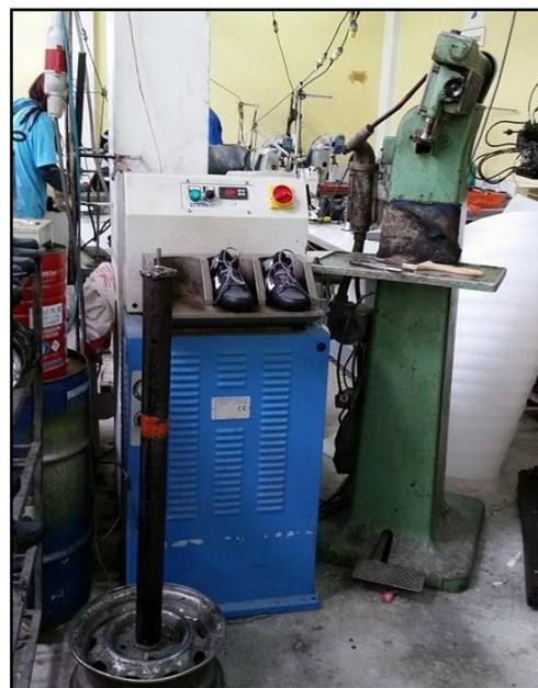
**Armar talones.** En este proceso el obrero coloca el zapato para cerrar talón mientras opera la máquina saca las grapas de la horma, al sacar el zapato se le da unas pequeñas martilladas para ajustar el corte en la horma.
