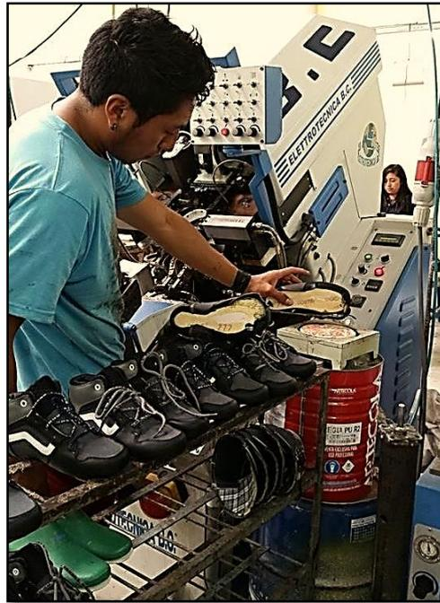
**Armar laterales.** El obrero primero vaporiza el corte armado la punta para luego cerrar laterales siempre y cuando el corte este bien vaporizado permite un cierre adecuado del zapato.
