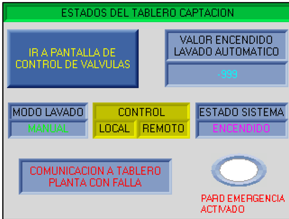
Figura 4.101 Pantalla HMI control de estado Captación
