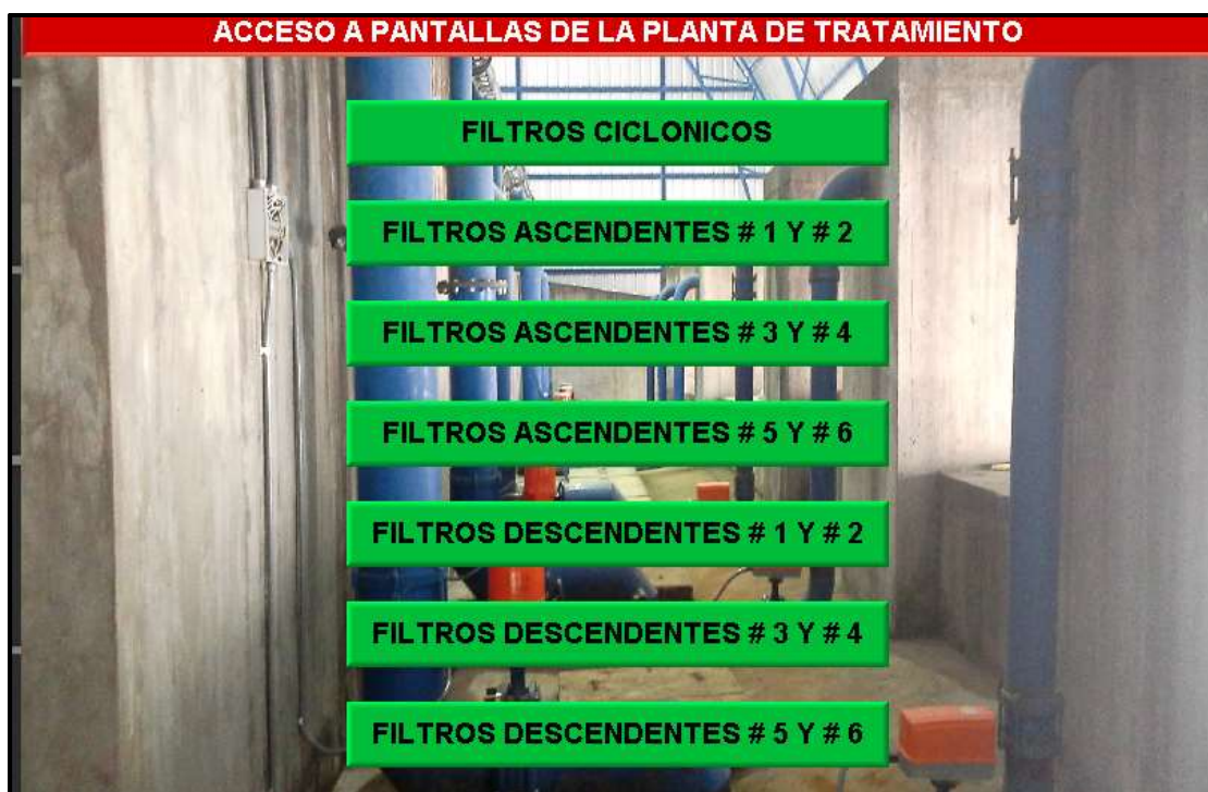
Figura 4.98 Pantalla principal HMI de Planta de Tratamiento
