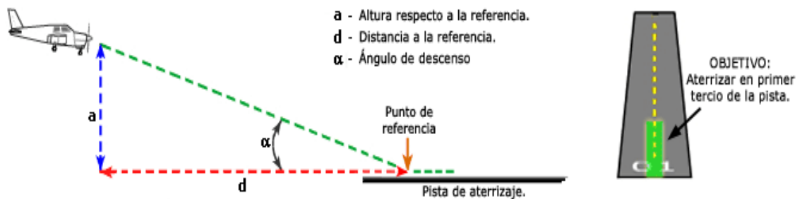
Fig. 2.14: Geometría de aproximación final (senda de descenso). Fuente. Fundamentos de Ingeniería Aeronáutica. [9].
