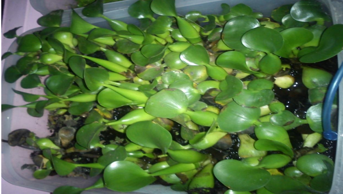
Imagen F-35: Estanques de fitorremediación con Lechuguín ( Eichhornia crassipes ) para el agua residual industrial (Lavadora de Jeans) a escala de laboratorio
