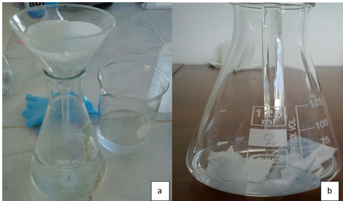
a) Proceso de filtración y disolvente (Hexano), b) Extracción de la grasa y aceite de los trozos de papel filtro
