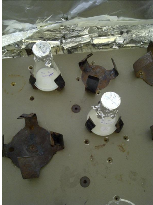
Fotografía C9. Soluciones de proteasas con sustrato (suero lácteo) colocadas en el agitador NEW BRUNSWICK SCIENTIFIC (provisto de regulación de temperatura y agitación) listas para la incubación.
