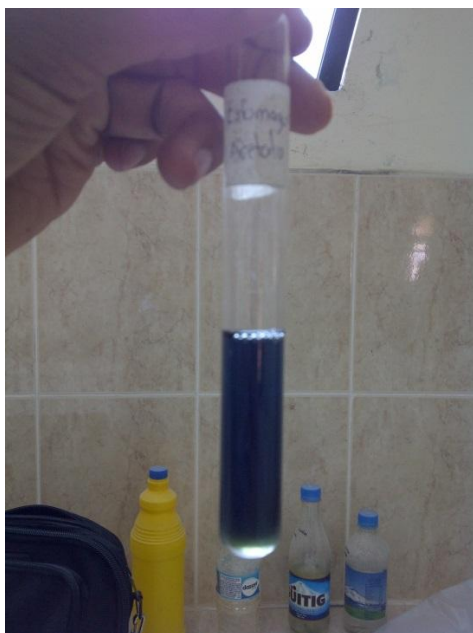
Fotografía C5. Solución de proteasas del estómago reaccionando con Lowry y Folin-Ciocalteu, previo a la lectura de Absorbancia a 500 nm en un espectrofotómetro.
