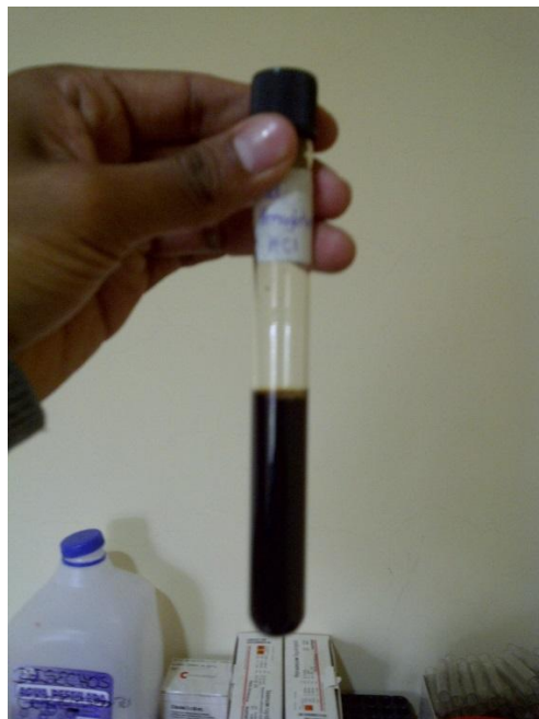
Fotografía C13. Suero lácteo en ácido clorhídrico (8 M) después de haber sido sometido a hidrólisis exhaustiva a 110°C por 48 horas.
