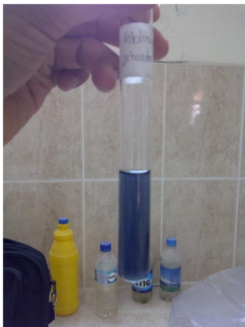
Fotografía C6. Solución de proteasas del intestino reaccionando con Lowry y Folin-Ciocalteu, etapa previa a la lectura de Absorbancia a 500 nm en un espectrofotómetro.
