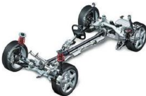
Figura 2-3 Esquema de los trenes de suspensión.
