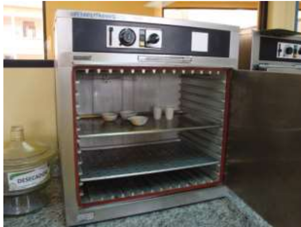
Figura 4.4 Determinación del contenido de humedad en estufa a 105°C durante 24 horas
