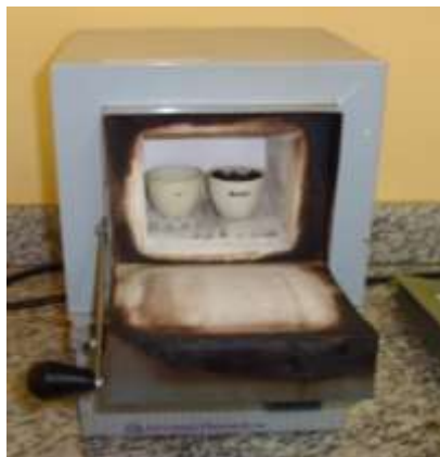
Figura 4.5 Horno de mufla para la determinación del contenido de cenizas Fuente: Laboratorios de la FCIAL
