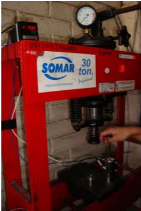
Figura 4.8 Proceso de peletizado en prensa hidráulica
