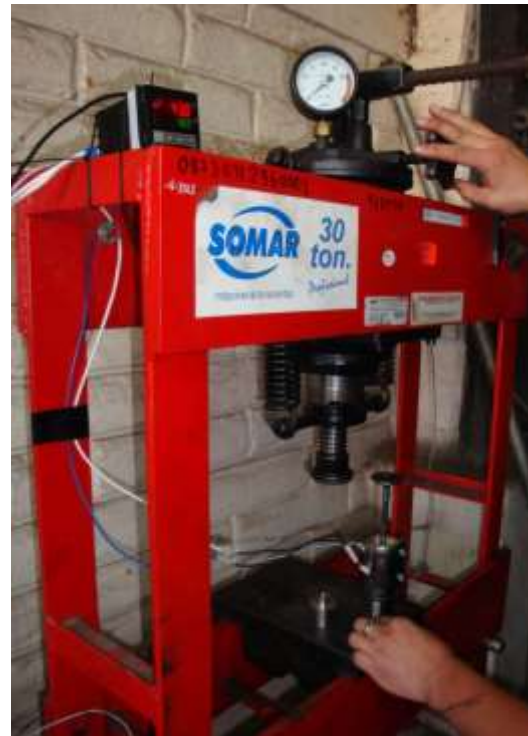
Figura 4.9 Proceso de peletizado en prensa hidráulica y matriz unitaria
