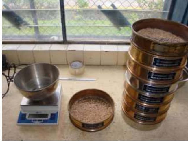
Figura 4.1 Tamices necesarios para realizar el ensayo Fuente: Laboratorios de Ing. Civil
