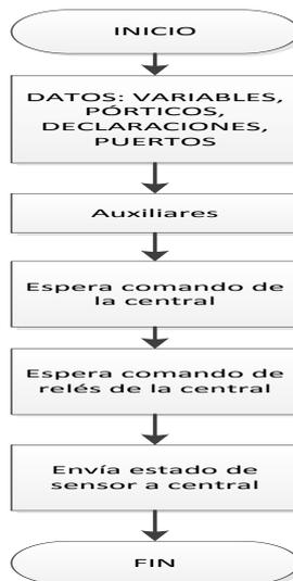
**Fig.63:** Diagrama de flujo estación remotas.
