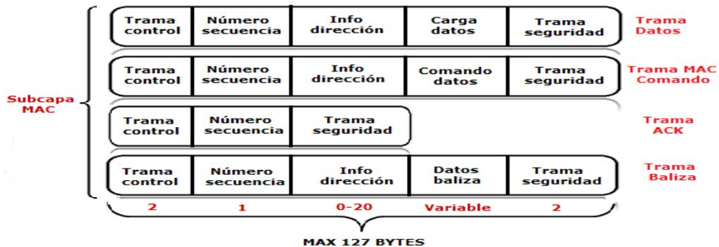
**Fig.16** Campos de los cuatro tipos de paquetes básicos de ZigBee.
