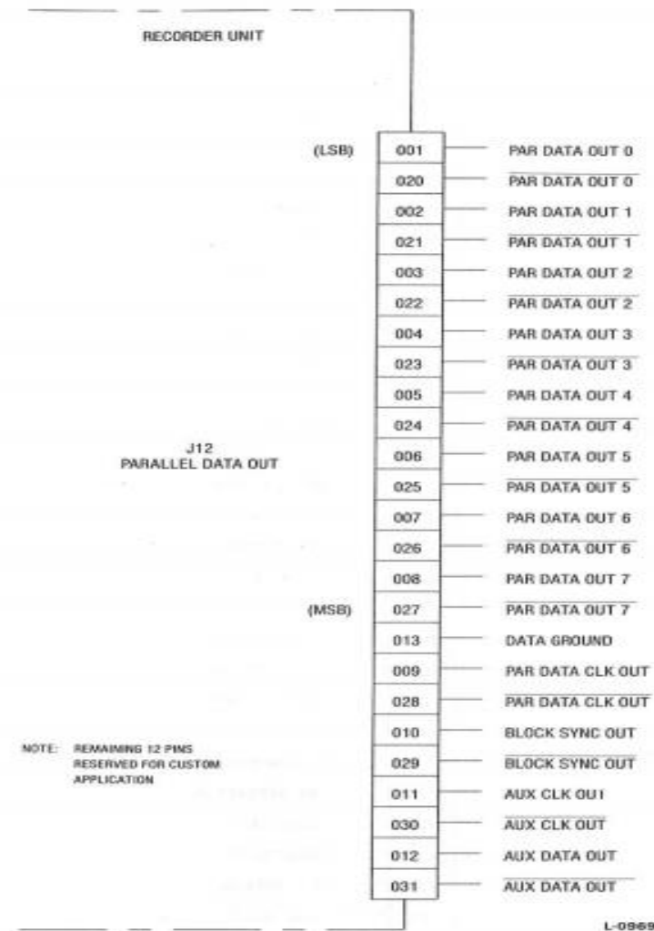
Figura 6.8: Diagrama de pines del puerto paralelo de salida de la grabadora DCRSi 240
