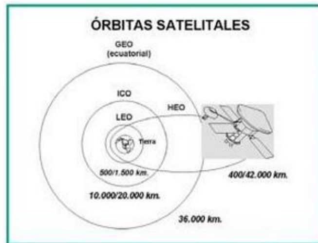
Figura 2.11: Distintas órbitas a las que se sitúan los satélites de comunicaciones Fuente: Sistemas telemáticos de José Manuel Huidobro pág. 169
