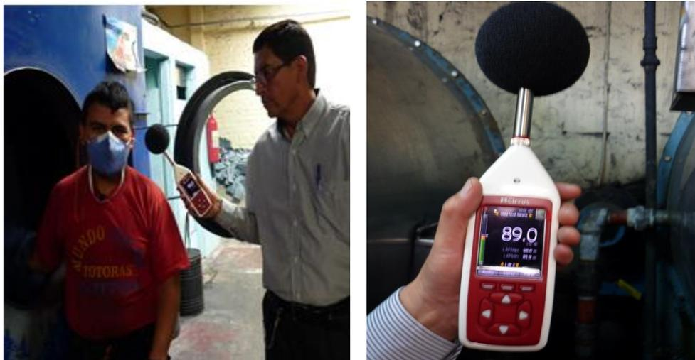
Ilustración 18.- Mediciones de ruido área de secado
