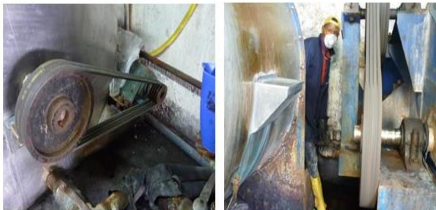
Ilustración 22.- Riesgo de atrapamiento por mecanismos móviles descubiertos
