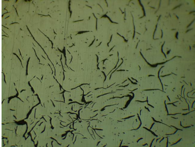
Figura 4.75 Metalografía.Oxidación térmica. Fundición gris T650°C. Sin ataque. 100X.
