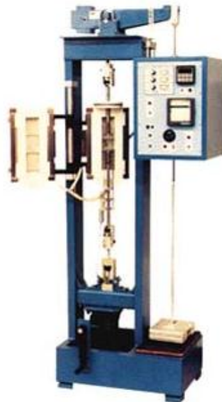
Figura 2.16 Equipo para Ensayo de Fluencia a Elevada Temperatura
