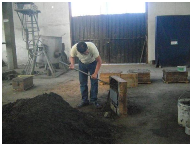
Figura 6.24 Desmoldeo de las cajas. 24 horas de haber realizado el colado (Fuente: Autor)
