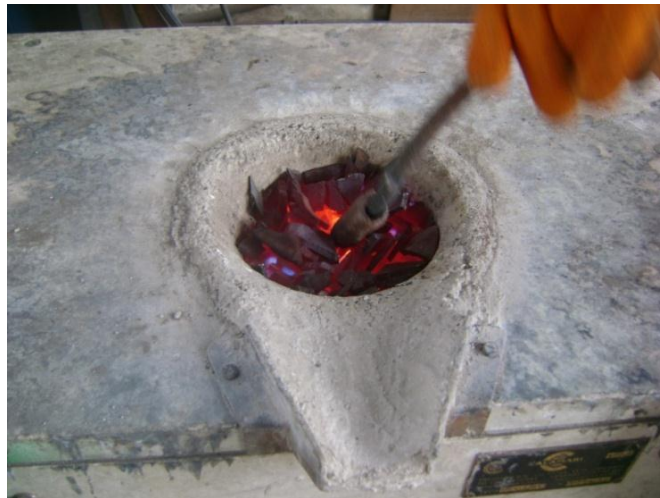
Figura 6.18 Carga y fusión de la chatarra (Fuente: Autor)
