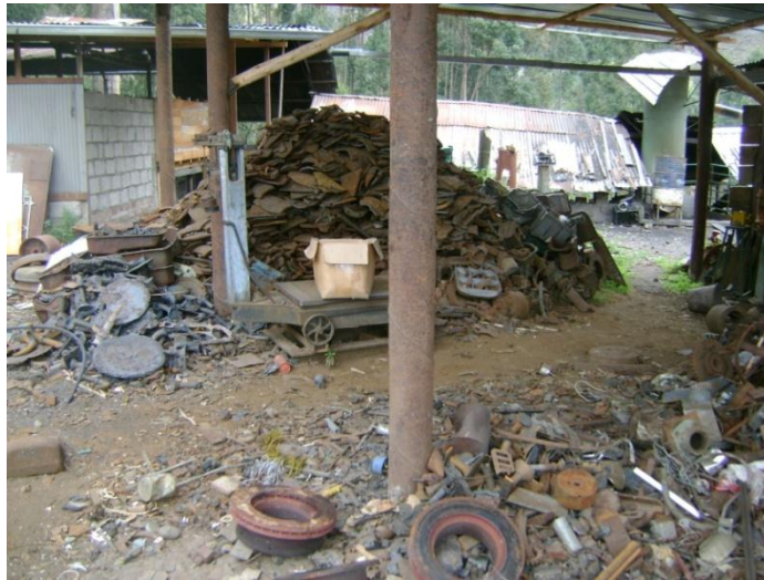
Figura 6.15 Materia prima para la fundición (Chatarra). Desechos de fundición gris
