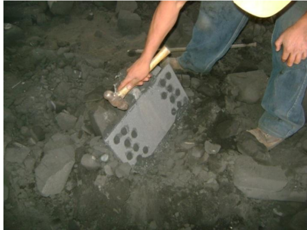
Figura 6.25 Obtención del espejo de fundición gris perlítica (Fuente: Autor)
