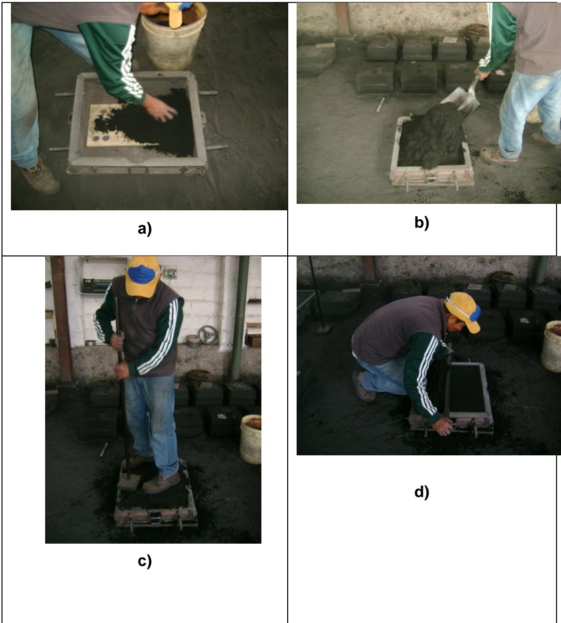
Figura 6.17 Construcción del molde. a) Colocación del molde en la caja. Ponemos la arena de contacto b) Completamos con arena la caja c) Compactación de la arena d) Extracción de exceso. Alisado de arena
