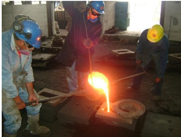
Figura 6.23 Colado de los moldes de arena. Retención de escoria (Fuente: Autor)
