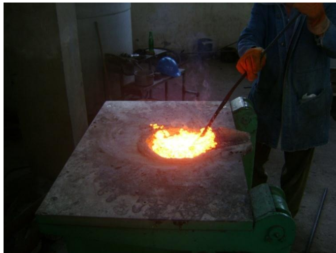
Figura 6.19 Extracción de la escoria. Homogenización de la colada (Fuente: Autor)
