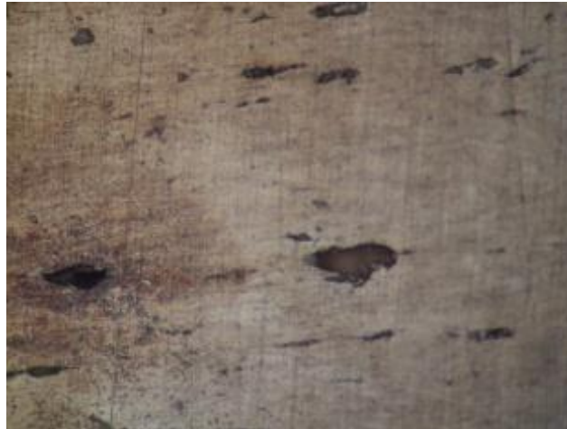
Figura 4.39 Distancia 100 \mu m de la fractura. Fotomicrografía a 400X. Se observan cavidades mucho mas grandes alargadas en la dirección de la carga aplicada. Acero A36. Atacada con Nital 4. T 650°C
