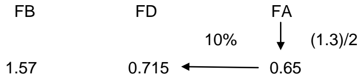
Figura 6.13 Corrección de la relación de secciones del sistema de alimentación (Fuente: Autor)
