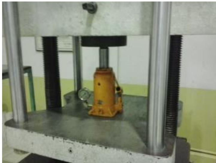
Figura 4.4 Calibración de la gata hidráulica en la Máquina Universal Tinus Olsen capacidad 100000 Kg. (Fuente: Autor)
