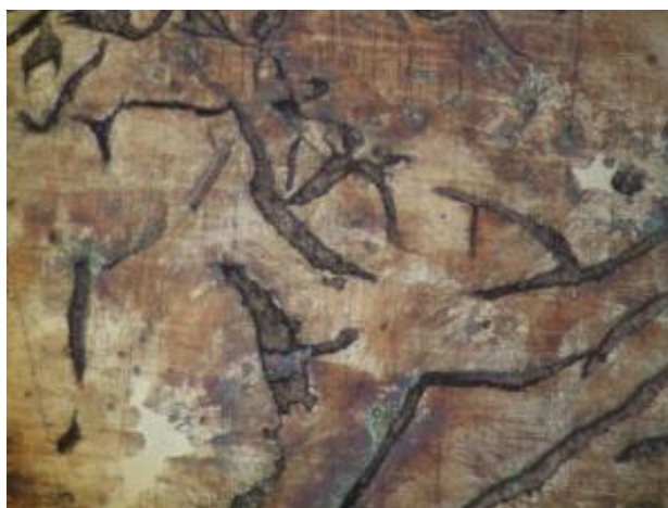
Figura 4.67 Fotomicrografía fundición gris. Termofluencia 650°C.100X. (Fuente: Autor)
