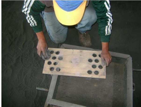
Figura 6.6 Modelo de madera para la obtención del espejo (Fuente: Autor)
