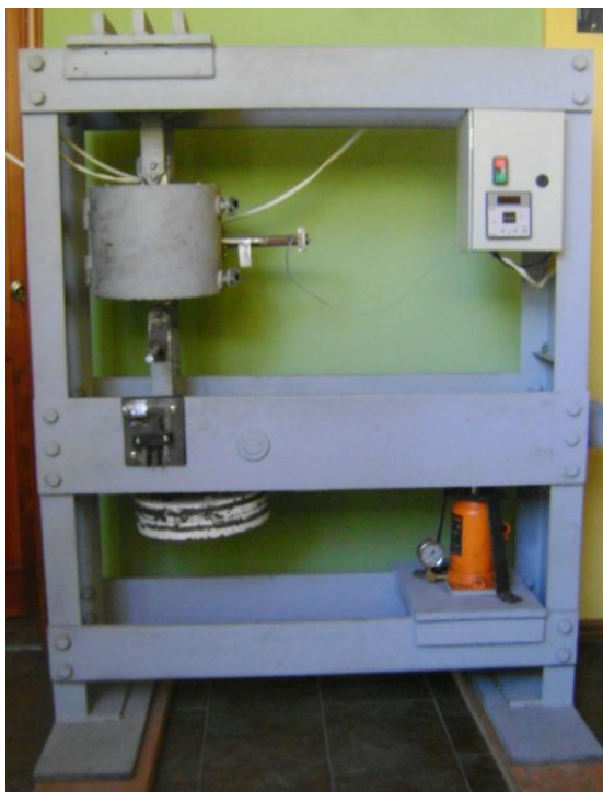
Figura 4.23 Máquina de termofluencia durante la realización del ensayo a 500°C, carga aplicada al espécimen de 2448 Kgf. Acero ASTM A36.
