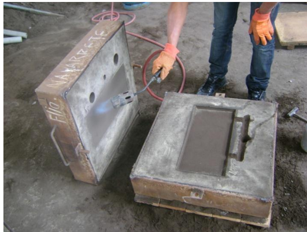
Figura 6.22 Calentamiento de las caras de la caja que tomaran contacto con la colada (Fuente: Autor)
