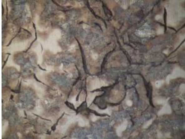
Figura 4.66 Fotomicrografía fundición gris. Termofluencia 600°C.400X. (Fuente: Autor)
