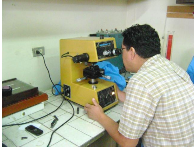
Figura 4.40 Microdurómetro. Obtención de microdureza. Termofluencia ASTM A36.
