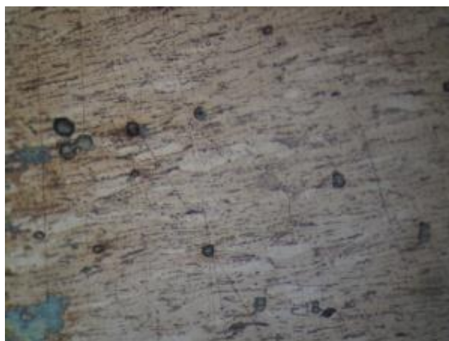
Figura 4.37 Distancia 100µm de la fractura. Fotomicrografía a 400X. Se observan cavidades esféricas. Acero A36. Atacada con Nital 4. T 550°C.
