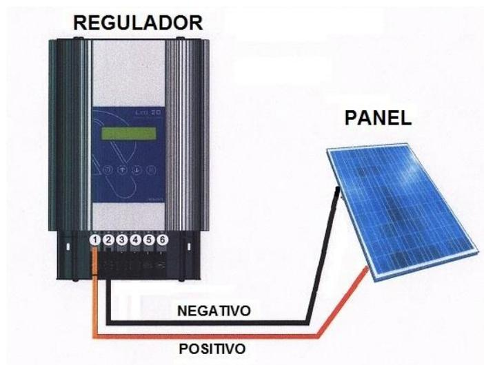
**Figura 6.2 Regulador o controlador de carga**
