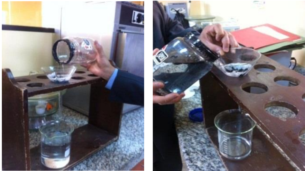
Figura 4-7 Filtración del agua contaminada
