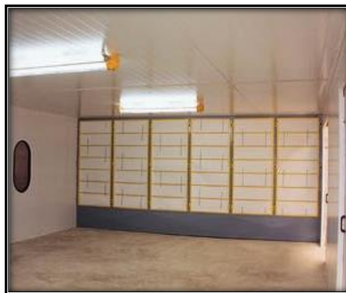
Figura 2-3: Sistema de acabados en seco
