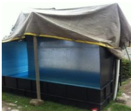
Figura 4-2 Cámara de acabados para muebles de madera con cortina de agua
