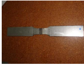
Figura 2.16: Probetas para ensayo de tracción, acero AISI 304.
