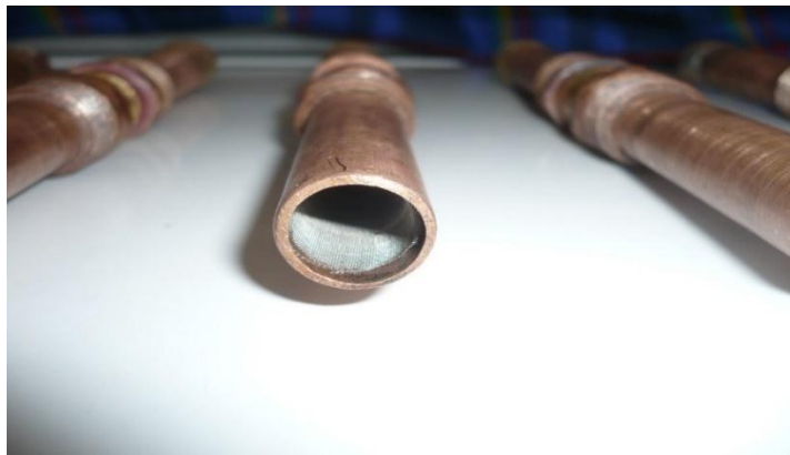
Figura 6. 2 Malla #80 de acero inoxidable instalada dentro del contenedor. Elaborado por: Ing. Luis Escobar
