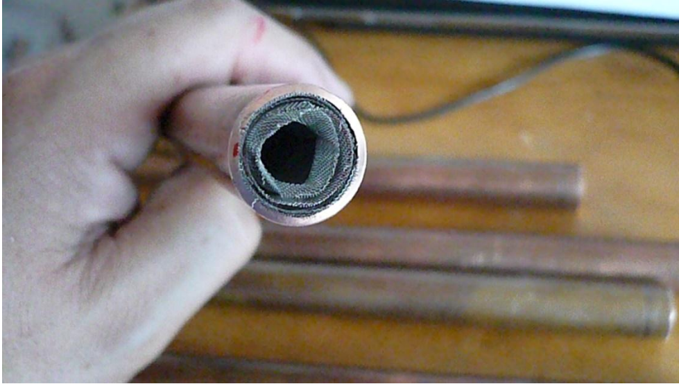
Figura 4. 4 Varias mallas o mechas dentro del tubo de calor (vista frontal) Elaboración: Ing. Luis Escobar
