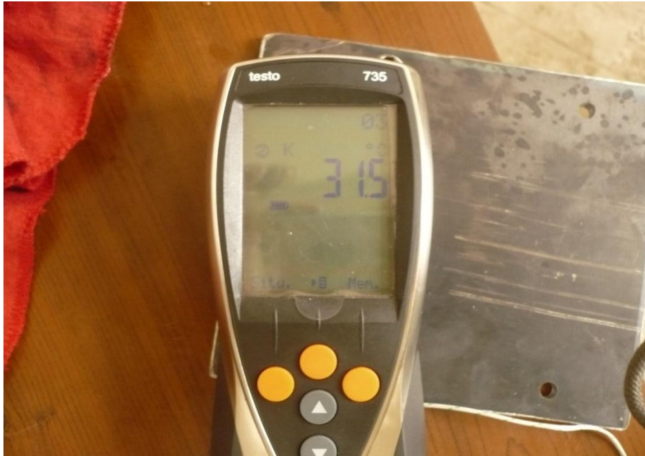
Figura 6. 9 Temperatura de salida del Intercambiador de Calor.
