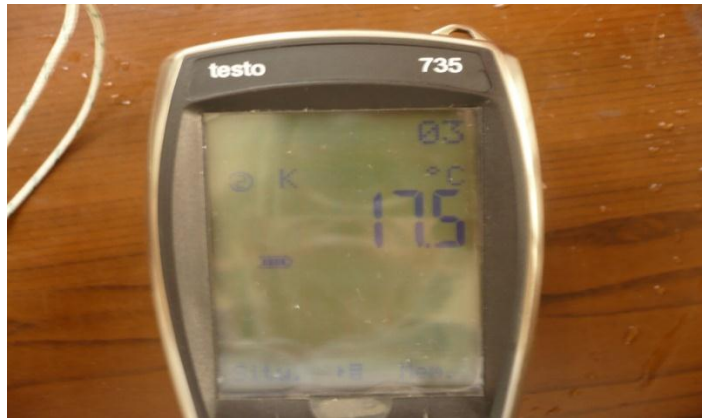
Figura 6. 7 Temperatura de ingreso al Intercambiador de Calor. Elaborado por: Ing. Luis Escobar
