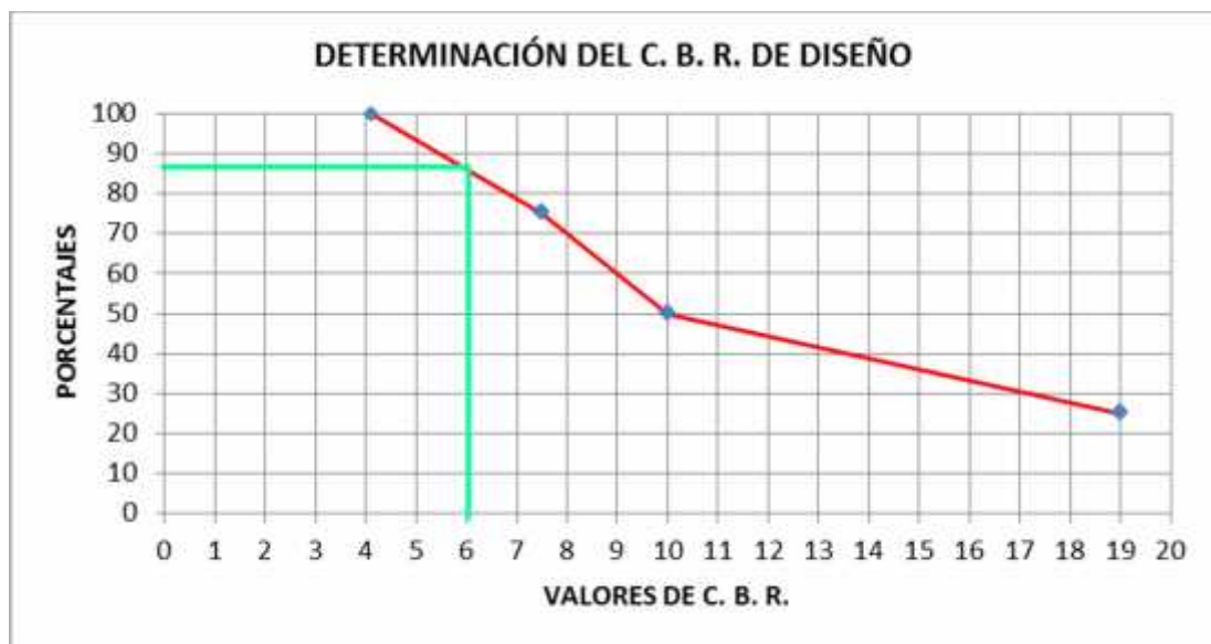
Gráfico N° 6.6: Determinación del CBR de Diseño.
