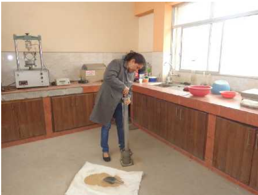
Compactación por capas
