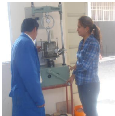
Aplicando las cargas al molde
