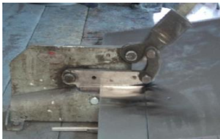
Ilustración 43. Corte de las planchas para el tambor y su base
