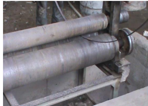
Ilustración 45. Rolado de las platinas
