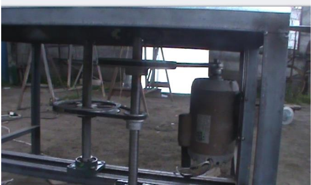
Ilustración 55. Montaje de los ejes
