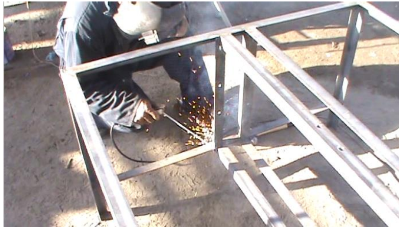
Ilustración 42. Soldadura de la bancada de la lavadora
