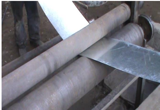
Ilustración 44. Rolado del acero
