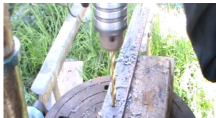
Ilustración 41. Perforación para ajuste del motor y rodamientos
