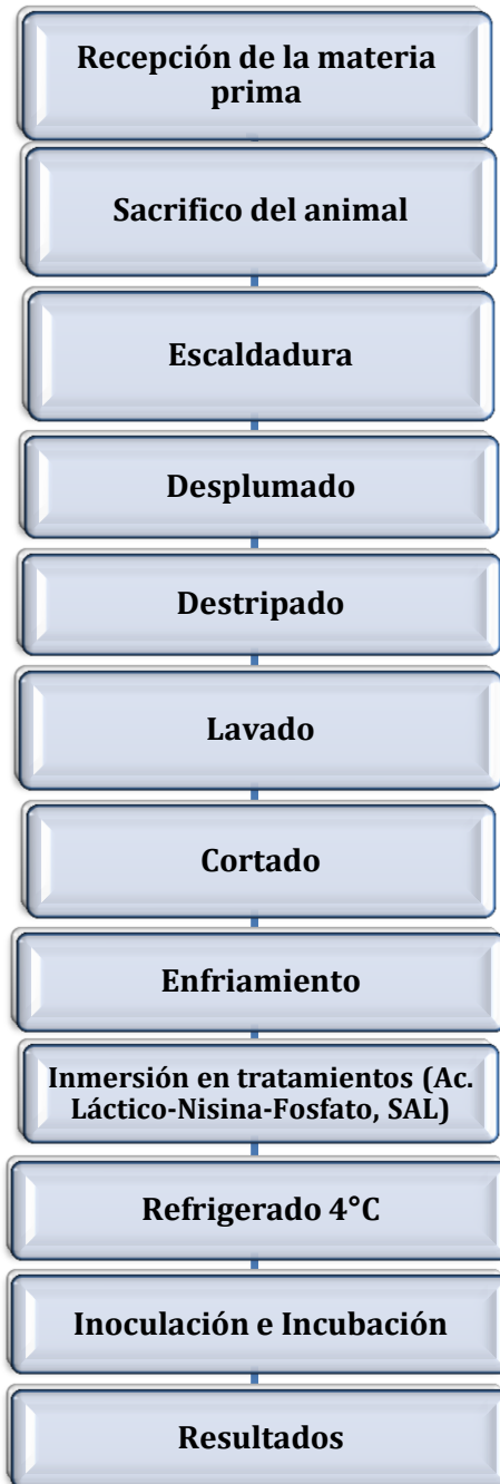
Diagrama E-1: Diagrama de flujo del proceso de aplicación de tratamientos en la carne de pollo.
