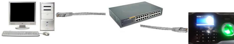
**Figura 6.122.** Conexión mediante un switch o hup
