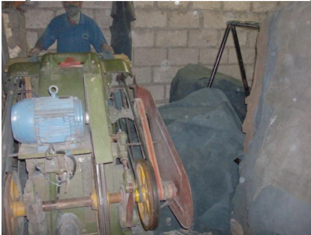
Riesgo Físico: Sin ventilación, mascarilla inadecuada y espacio reducido.
