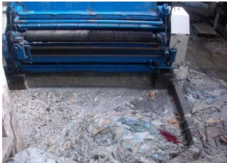
Figura 18: Acumulación de desechos en la máquina Descarnadora Fuente: El Investigador
