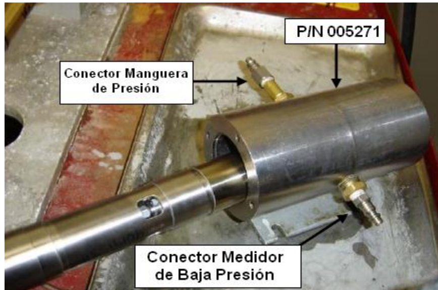
Figura N° 6.6.3.3.1 c) Insertar la cubierta del pistón.
