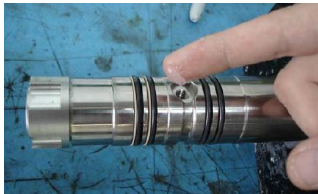
Figura N o 6.6.3.2.2 b) Aplicación de grasa en los o-rings.
