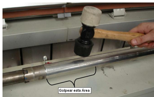
Figura N° 6.6.3.2.1 v) Dando golpes en CMS para simular vibración.
