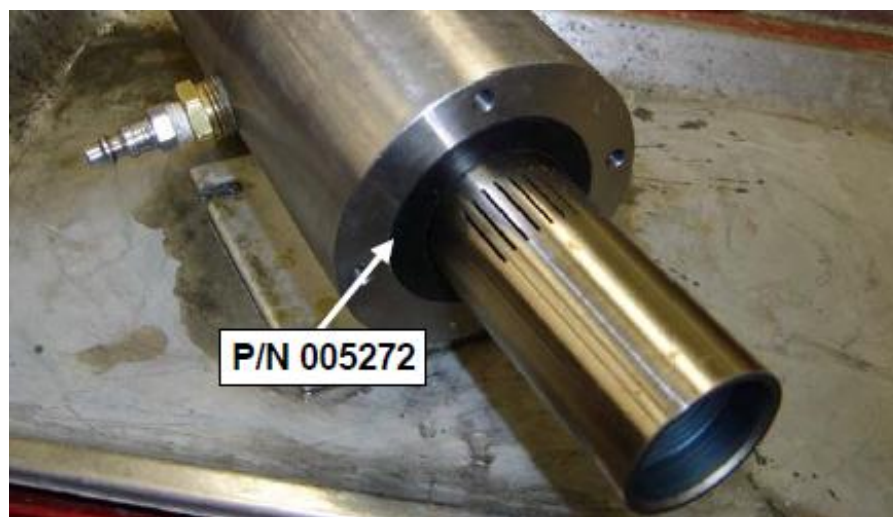
Figura N° 6.6.3.3.1 d) Colocación del seal ring.
