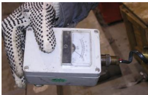
Figura N° 6.6.10 Battery Tester Elaborado por: La investigadora
