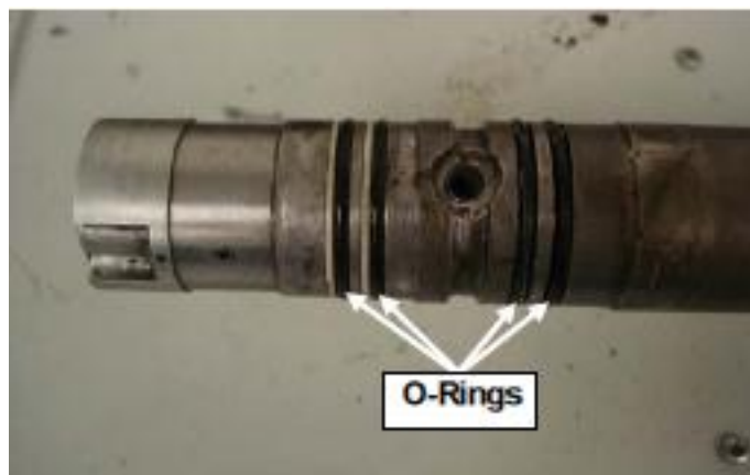
Figura N° 6.6.3.2.1 d) Desensamble de CMS. Elaborado por: La investigadora
