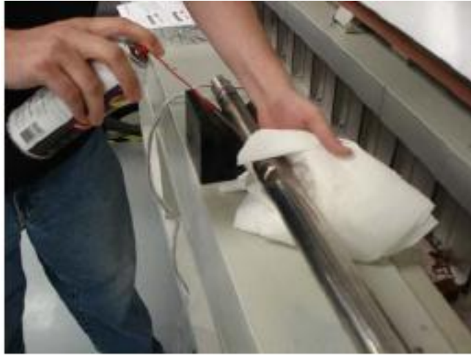
Figura N° 6.6.3.2.1 c) Limpieza de CMS. Elaborado por: La investigadora
