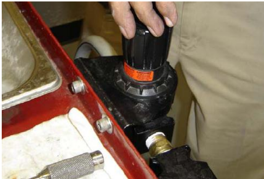
Figura N° 6.6.3.3.1 q) Ajuste del regulador neumático.
