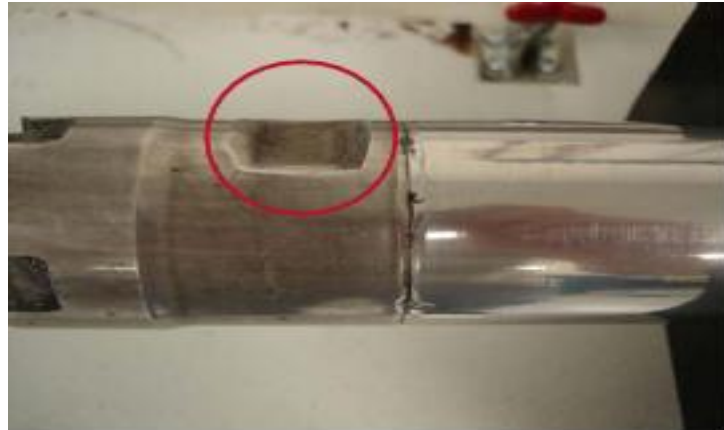
Figura N° 6.6.3.2.1 j) Inspección de desgaste en pestañas de torque.
