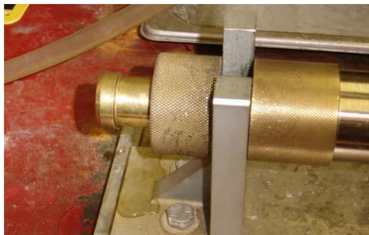
Figura N° 6.6.3.3.2 b) Verificación de fuga. Elaborado por: La investigadora
