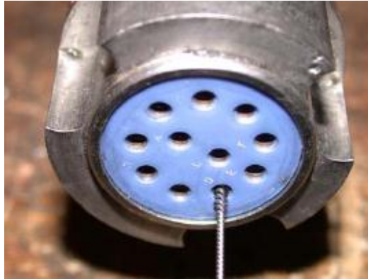
Figura Nª 6.6.3.2.1 o) Limpieza del conector de 11 pines. Elaborado por: La investigadora
