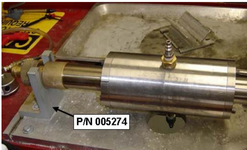
Figura N° 6.6.3.3.1 j) Colocación en el End Support. Elaborado por: La investigadora
