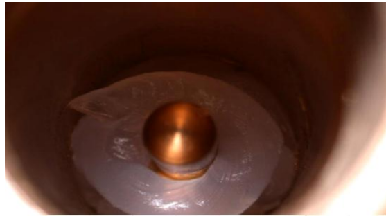
Figura N° 6.6.3.1.1 k) Aplicación de segunda capa de grada en el pin de la CDS. Elaborado por: La investigadora
