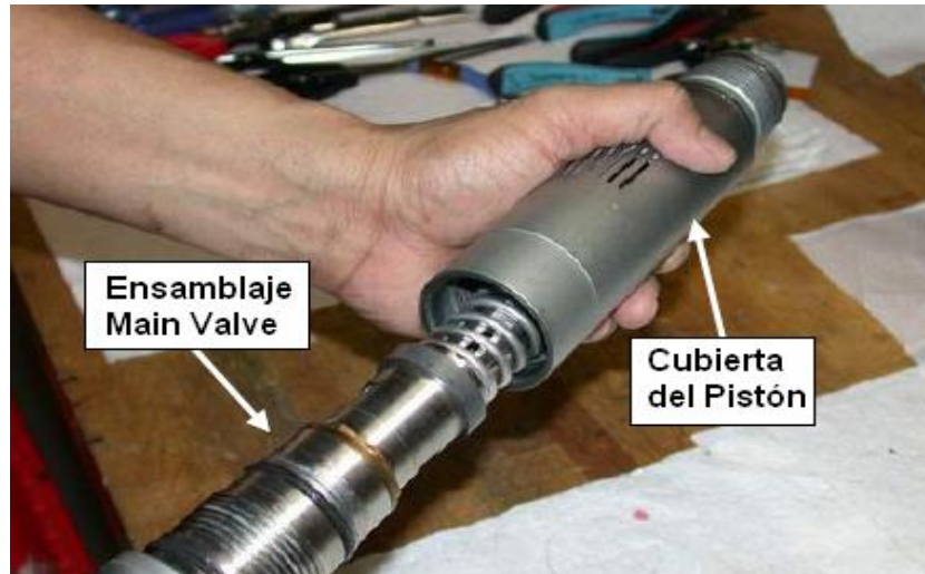
Figura N° 6.6.3.3.1 a) Separación de la cubierta de la Main Valve. Elaborado por: La investigadora
