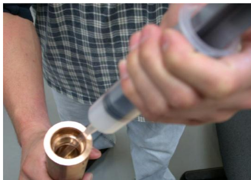
Figura N o 6.6.3.1.1 i) Inyectar la grasa alrededor del pin en la CDS.
