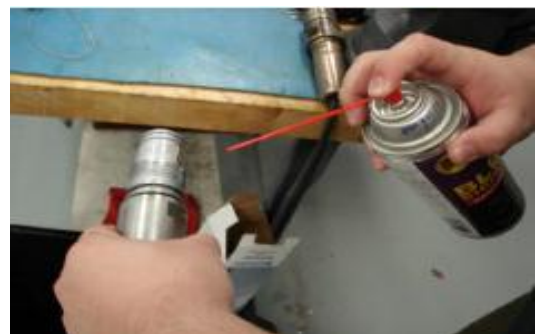
Figura N° 6.6.3.1.1 b) y c) Limpieza de extensión a la batería en la BTR. Elaborado por: La investigadora
