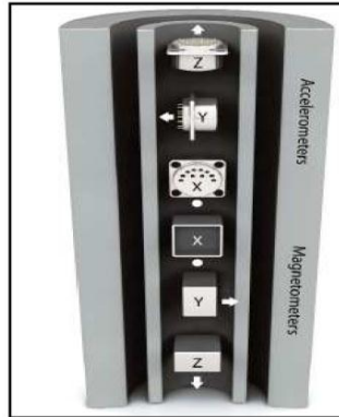
Figura N° 6.4 Arreglo de los acelerómetros y magnetómetros
