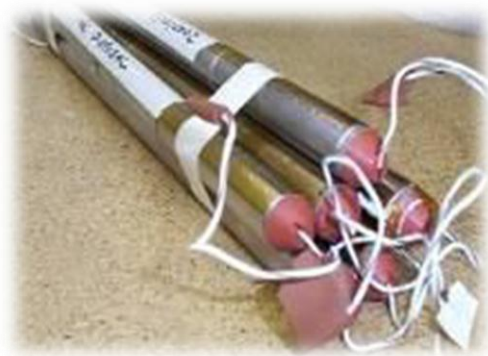
Figura N o 6.6.9 Celdas de baterías de Litio Elaborado por: La investigadora
