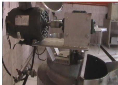
6. Sistema de batido instalado
