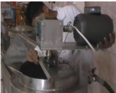
5. Instalación del sistema de batido (3)
