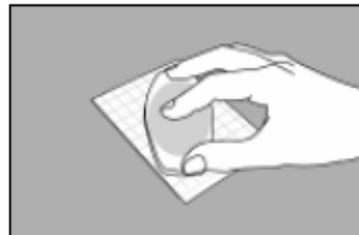
**11** Presione suavemente el dispensador o esparcidor para distribuir la muestra sobre el área circular. No gire ni deslice el dispensador. Recuerde distribuir la muestra antes de inocular una siguiente placa.
