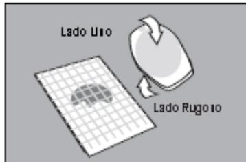
**10** Con el lado rugoso hacia abajo, coloque el dispensador o esparcidor sobre la película superior, cubriendo totalmente la muestra.
