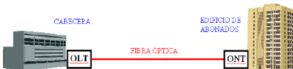
Figura 24. Elementos básicos de la arquitectura FTTB.
