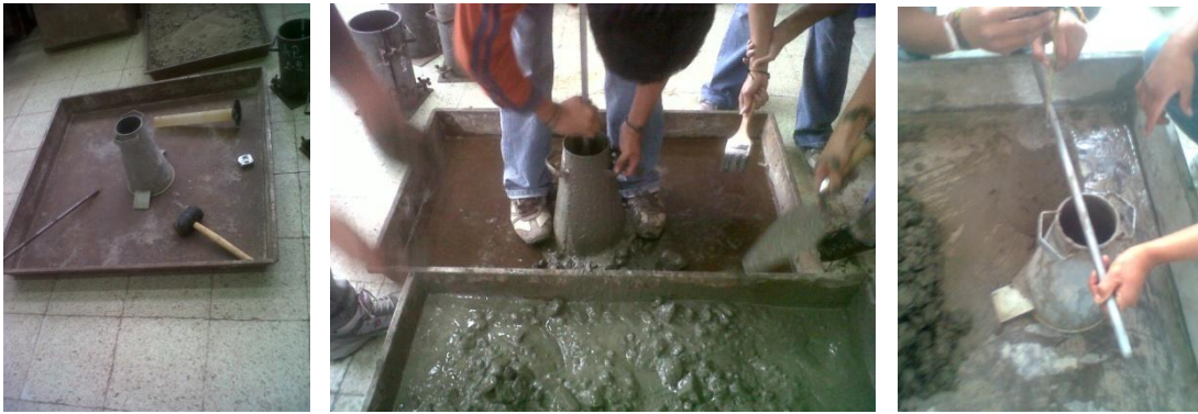
Ensayo del Cono de Abrams
