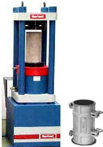
Gráfico # 4 Ensayo de compresión del hormigón
