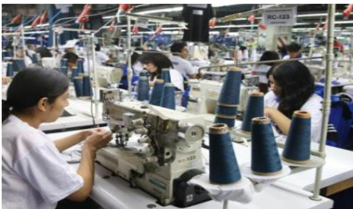
*Detalle: En el área de confección se receipta las prendas cortadas, para unir las piezas mediante las máquinas de coser. Cada persona debe saber utilizar las diferentes máquinas para un mayor rendimiento operativo en la empresa.*
