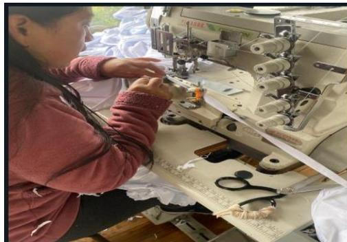
**Ilustración 20.** *Colocación de argollas*
