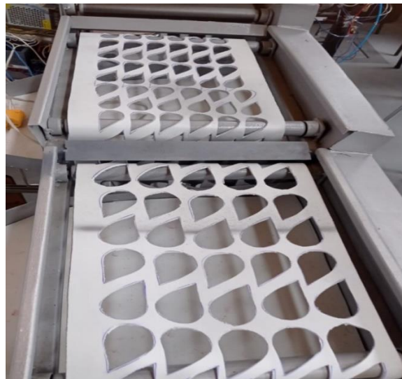
Figura 26. Banda troquelada de la banda 1 y 2.
