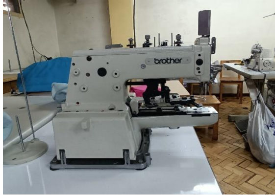
Figura 11. Botonera utilizada para el proceso de acabados.
