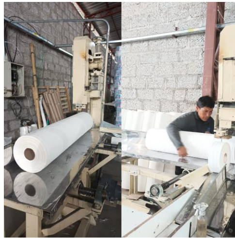
Figura 25. Proceso de corte de papel higiénico industrial
