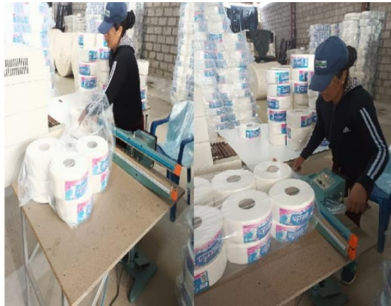
Figura 28. Empaquetado y sellado de papel higiénico industrial
