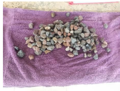
Secado del agregado grueso
