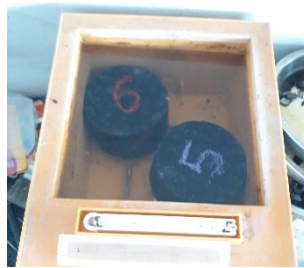
Gráfica 7. Baño María de las briquetas a 25 °C
