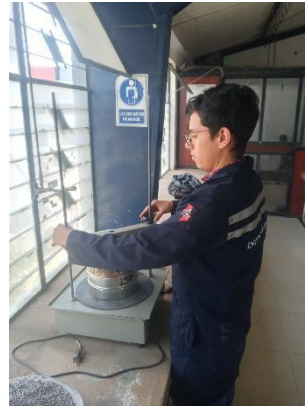
Tamizado del agregado
