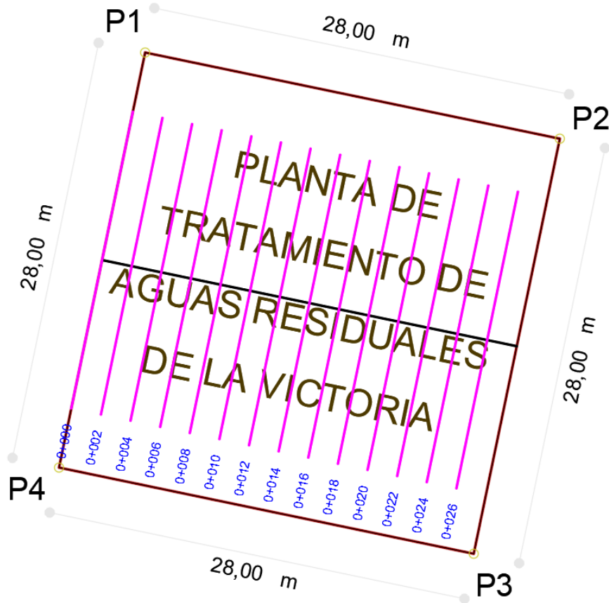
Figura 9. Vista en planta del corte para el detalle del perfil del terreno.
