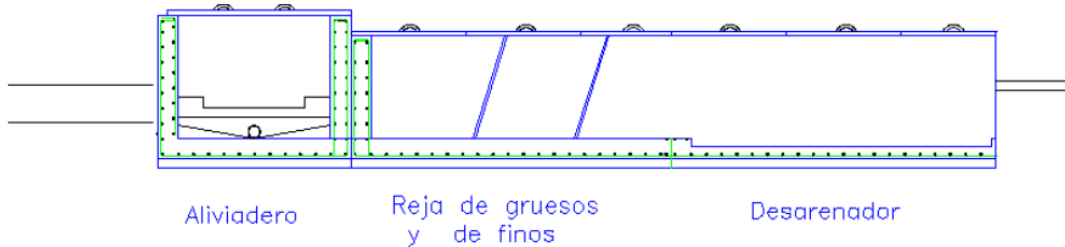
Figura 2. Esquema básico de Desarenador
