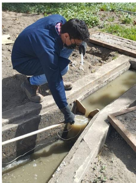
Figura 16. Medición de caudales afluente.
