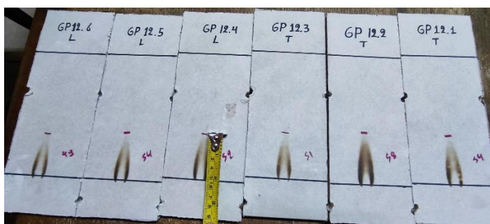
Ilustración N° 38 Medición factor Fs. Gypsum 12mm
