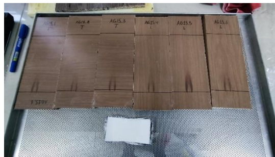
Ilustración N° 28 Muestras ensayadas de Melamina 15mm
