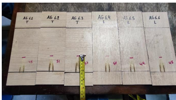
Ilustración N° 36 Medición factor F_s Melamina 6mm
