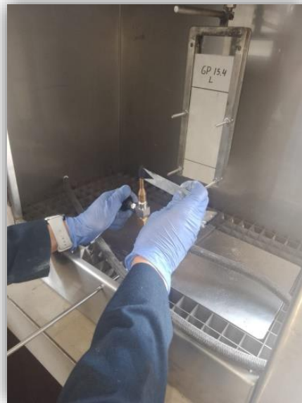
Ilustración N° 09 Calibración de llama a 20mm.
