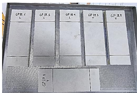
Ilustración N° 26 Muestras acondicionadas Gypsum 12mm
