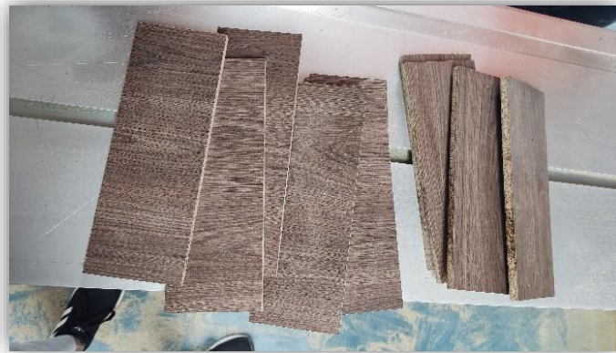
Ilustración N° 04 Corte longitudinal y transversal de muestras.
