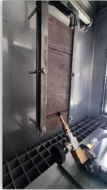
Ilustración N° 08 Comprobación de separación de quemador
