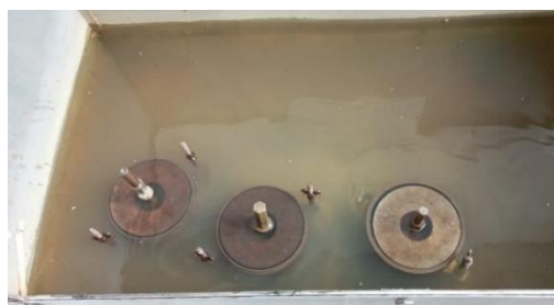
Figura 24. Moldes CBR sumergidos
