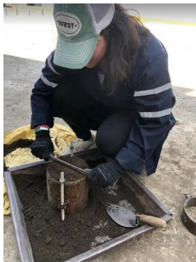
Descripción: Ejecución de ensayo proctor modificado.
