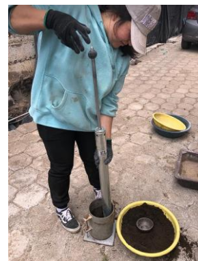
Descripción: Golpes con martillo para la muestra de ensayo CBR.
