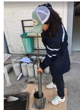
Descripción: Ejecución de ensayo proctor modificado
