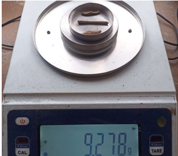
Figura N° 18.- Muestras para límite plástico
