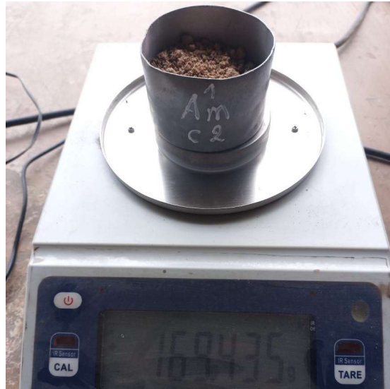
Figura N° 15.- Muestra para contenido de humedad
