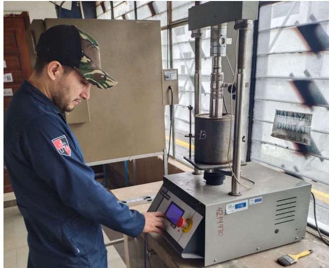
Figura N° 21.- Ensayo de compresión
