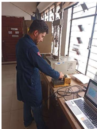
Ensayo de LL copa de Casagrande.
