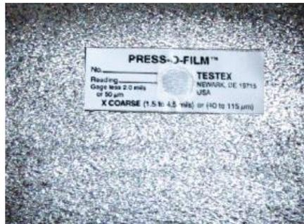
**Figura 1.21** Acabado generado por sandblasting [53].
