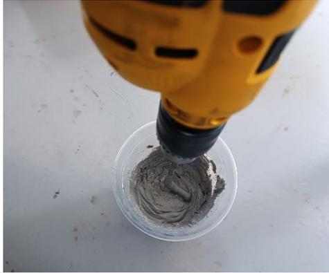
8. Aplicar la mezcla de componentes de resina en los moldes y dejar curar un tiempo estimado de 72h según el fabricante, para analizar las propiedades compresivas al cumplir este periodo.
