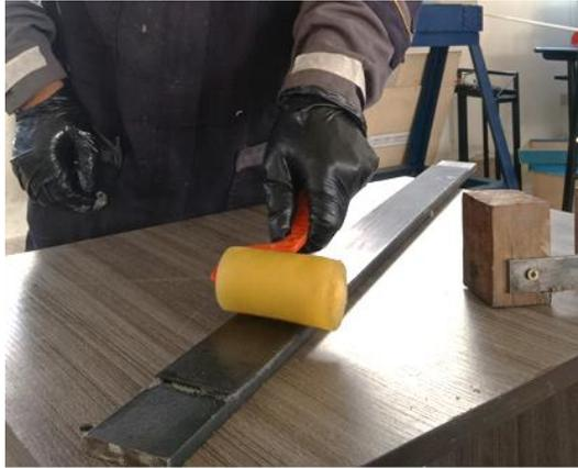
17. Ajustar la probeta mediante la prensa manual, adicionalmente se usó separadores de papel para evitar contaminaciones no deseadas.
