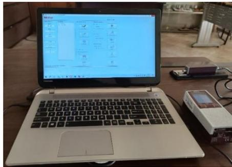
9. Medir rugosidad, ubicando las probetas en una superficie plana, para evitar fallos en la medición, además para la toma de datos se consideró ubicar al rugosímetro en diferentes posiciones.
