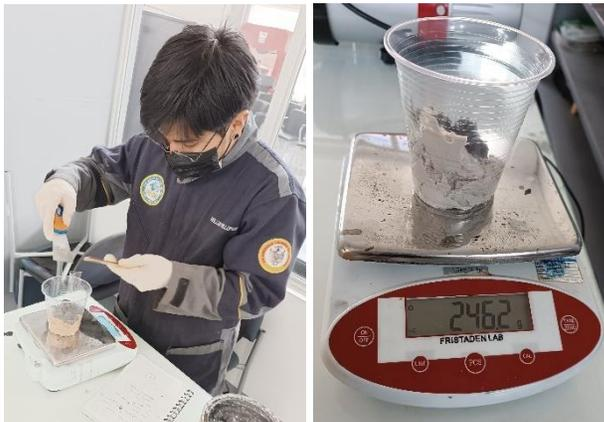
12. Mezclar durante 3 minutos las porciones de mezcla para la preparación de resina con un taladro de bajas revoluciones hasta reducir inclusiones de aire.
