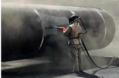
**Figura 1.20** Limpieza por maquina neumática - Granallado convencional [53].
