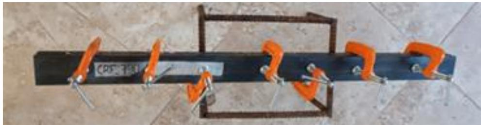
20. Ensayar por grupos de 5 probetas, primero las que no contenga reforzamiento, seguidamente de las probetas reforzadas en las mismas dimensiones.
