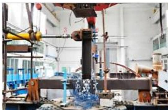
**Figura 1.16.** Calificación de conexión viga-columna [39].
