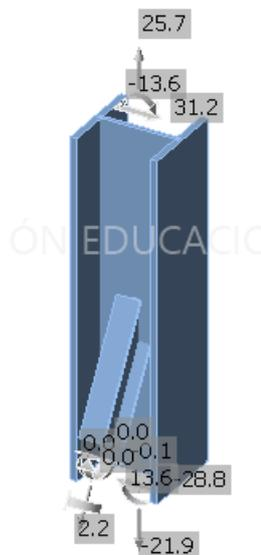
**Figura 3.21.** Fuerzas y momentos en conexión columna-soporte.
