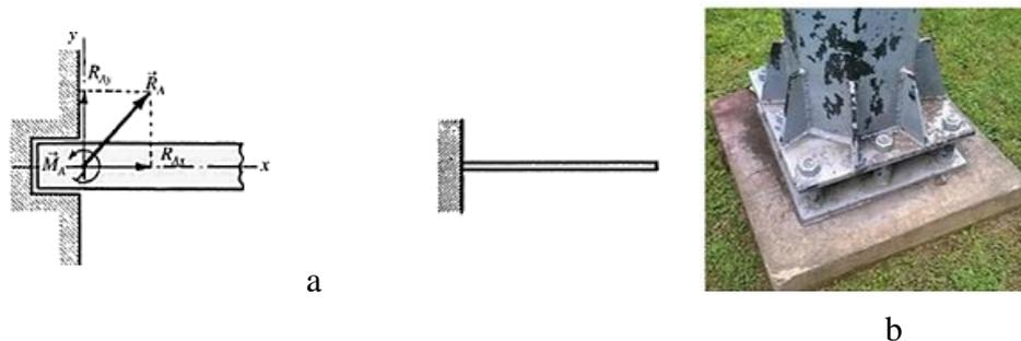
**Figura 1.14.** Apoyo fijo o empotrado: a) Reacciones y representación del apoyo, b) montaje de un apoyo fijo. [36].
