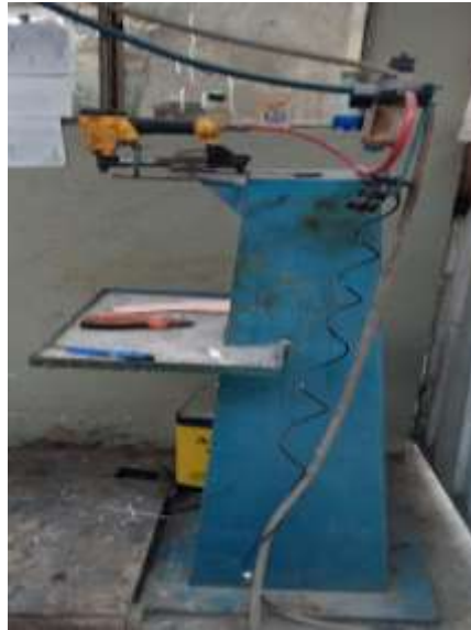
Figura 22 Máquina engrampadora-accionamiento neumático
