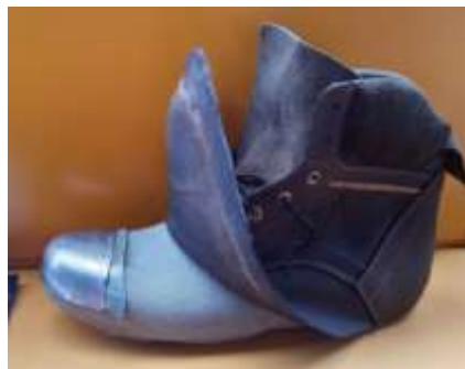
Figura 25 Fijado de punta metálica al calzado
