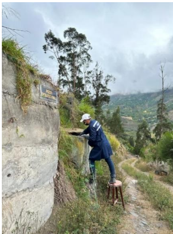
Figura 47. Medición del caudal de salida de la PTAR. Fuente: Autor
