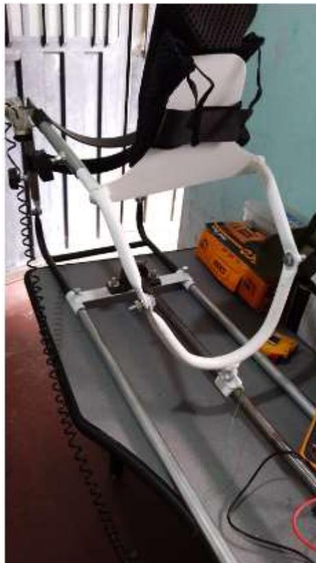
**Figura 26.** Estructura mecánica base del sistema con posapiés
