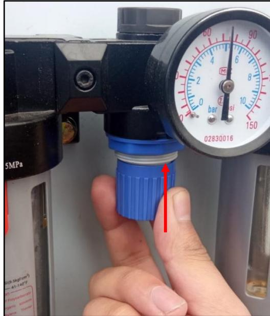
**Figura 89:** Aseguramiento del regulador de presión.
