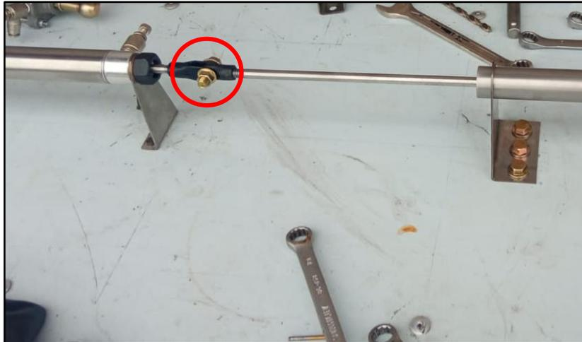
**Figura 90:** Unión de vástago y pistón.
