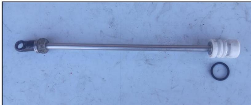
**Figura 93:** O-ring retirado de la ranura.
