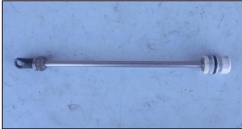
**Figura 92:** Pistón y vástago desacoplado.
