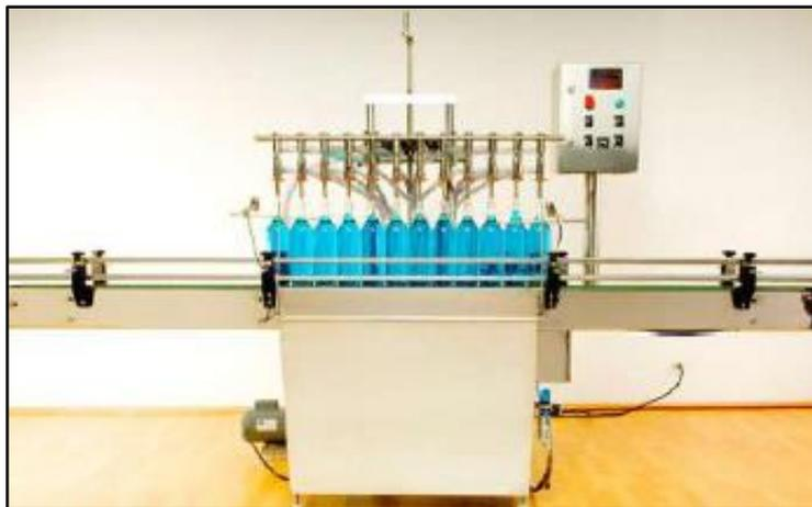
**Figura 6:** Envasadora lineal por nivel.[9]
