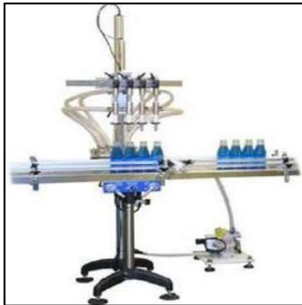
**Figura 9:** Envasadora de baja capacidad por nivel.[9]
