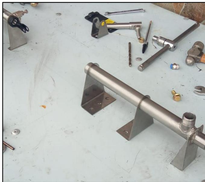
**Figura 91:** Vástago y pistón retirados del cilindro.
