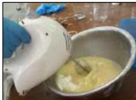
**Figura 20:** Mezcla del hidróxido de sodio con el aceite filtrado.[34]
