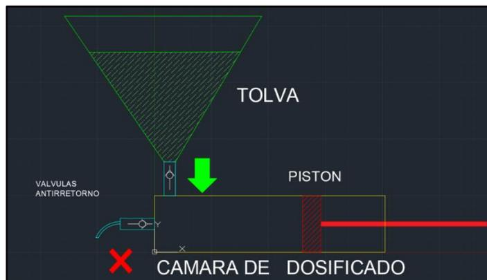
**Figura 40:** Diagrama del equipo durante la succión de producto.
