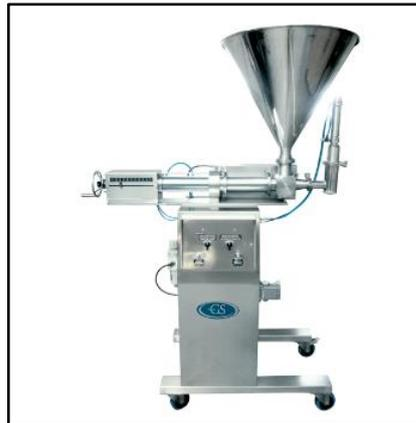
**Figura 10:** Envasadora de baja capacidad por volumen.[13]
