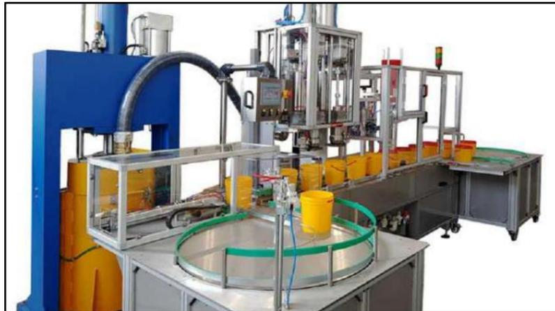
**Figura 7:** Envasadora lineal por volumen.[9]
