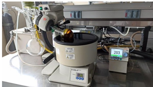
Figura 24. Eliminación de solvente mediante evaporación al vacío.
