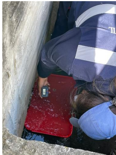
Figura 4. Medición del caudal de entrada de la PTAR
