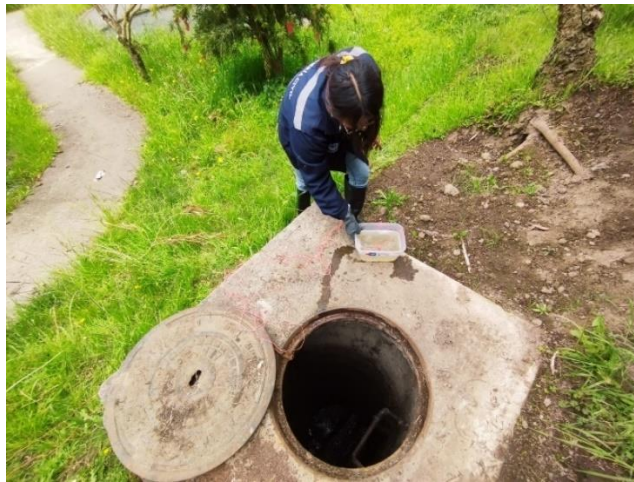
Figura 35. Toma de muestras de agua residual de salida de la PTAR
