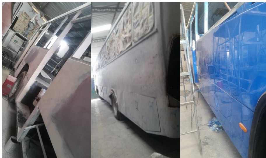
Fig. 12. Preparación y pintura.
