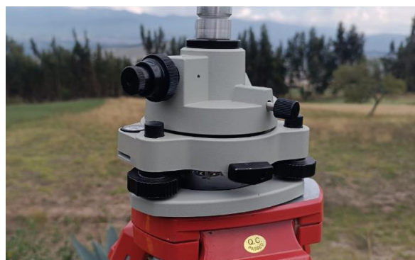
Figura 12.- Tripié con plato nivelante y plomada óptica
