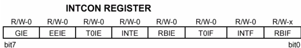
Figura 17. Bits correspondientes al registro INTCON
