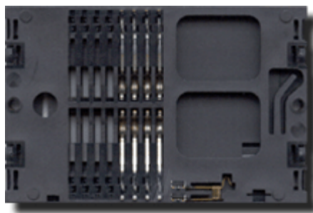
Figura 34. Vista posterior del zócalo para PCB de la Tarjeta Chip
