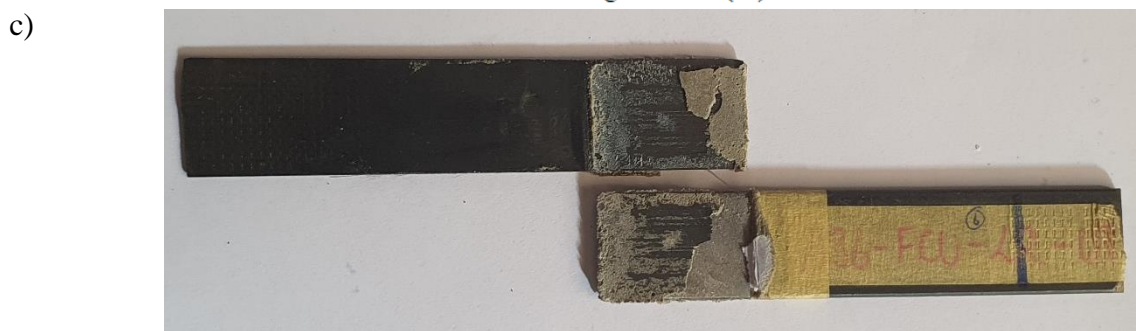
Figura 25. a) Gráfica Fuerza vs Desplazamiento b) Gráfica Esfuerzo vs Alargamiento c) Tipo de falla Adhesiva A36-FCU-LR-07
