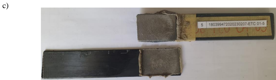
Figura 15. a) Gráfica Fuerza vs Desplazamiento b) Gráfica Esfuerzo vs Alargamiento c) Tipo de falla Adhesiva A36-FCU-CA-05
