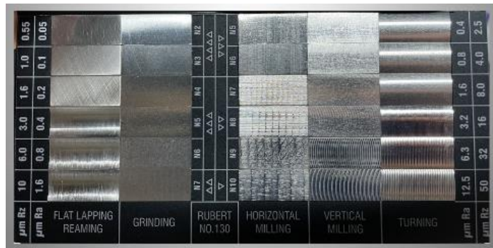
Figura 3. Set de muestras de rugosidad para comparación tacto/visual RB-set130 [51].
