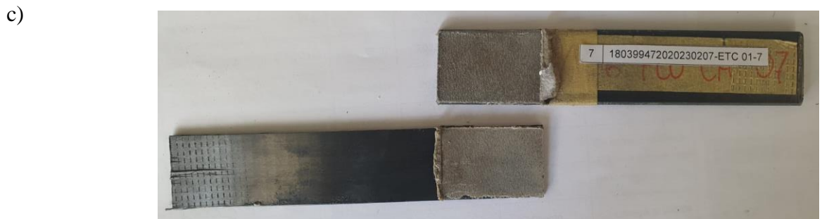
Figura 17. a) Gráfica Fuerza vs Desplazamiento b) Gráfica Esfuerzo vs Alargamiento c) Tipo de falla Adhesiva A36-FCU-CA-07
