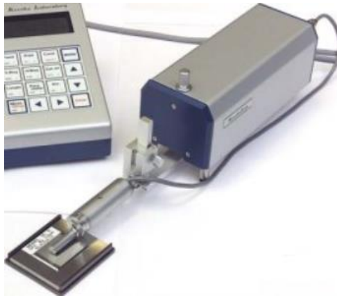
Figura 4. Rugosímetro de palpador mecánico de laboratorio SE-1200 KOSAKA [52].
