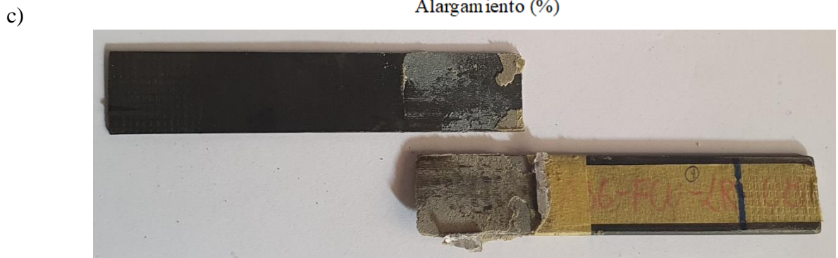
Figura 26. a) Gráfica Fuerza vs Desplazamiento b) Gráfica Esfuerzo vs Alargamiento c) Tipo de falla Adhesiva A36-FCU-LR-08
