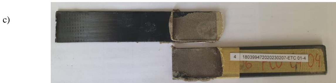
Figura 14. a) Gráfica Fuerza vs Desplazamiento b) Gráfica Esfuerzo vs Alargamiento c) Tipo de falla Adhesiva A36-FCU-CA-04
