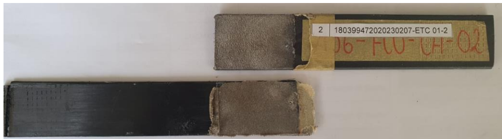
Figura 12. a) Gráfica Fuerza vs Desplazamiento b) Gráfica Esfuerzo vs Alargamiento c) Tipo de falla Adhesiva A36-FCU-CA-02
