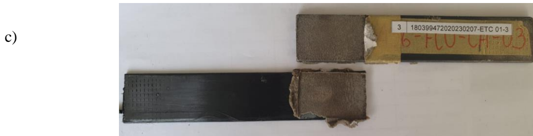
Figura 13. a) Gráfica Fuerza vs Desplazamiento b) Gráfica Esfuerzo vs Alargamiento c) Tipo de falla Adhesiva A36-FCU-CA-03
