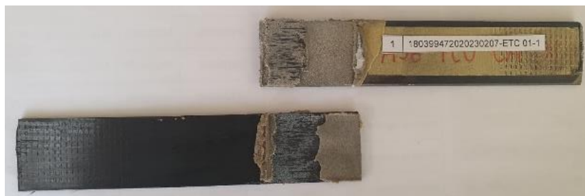
Figura 11. a) Gráfica Fuerza vs Desplazamiento b) Gráfica Esfuerzo vs Alargamiento c) Tipo de falla Adhesiva A36-FCU-CA-01
