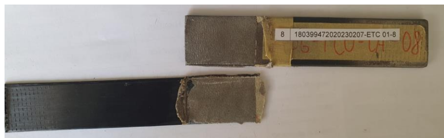
Figura 18. a) Gráfica Fuerza vs Desplazamiento b) Gráfica Esfuerzo vs Alargamiento c) Tipo de falla Adhesiva A36-FCU-CA-08
