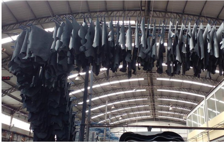
Imagen N° 11 Proceso de producción de la Curtiduría Tungurahua-Secado Aéreo
