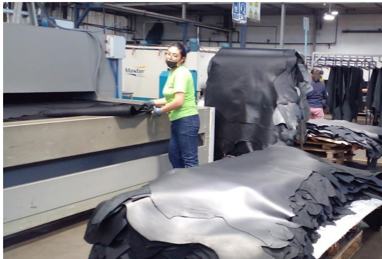
Imagen N° 12 Proceso de producción de la Curtiduría Tungurahua-Ablandado
